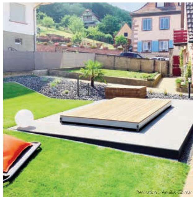
Cette terrasse mobile est une plateforme coulissante permettant de couvrir et découvrir la piscine. Elle est composée d'une structure en aluminium et d'un habillage prévu pour accueillir un plancher. Aquilus Piscines
